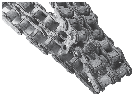
不锈钢传动链的腐蚀
